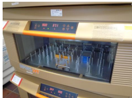
図 4 マイクロプレート用振とう培養器
