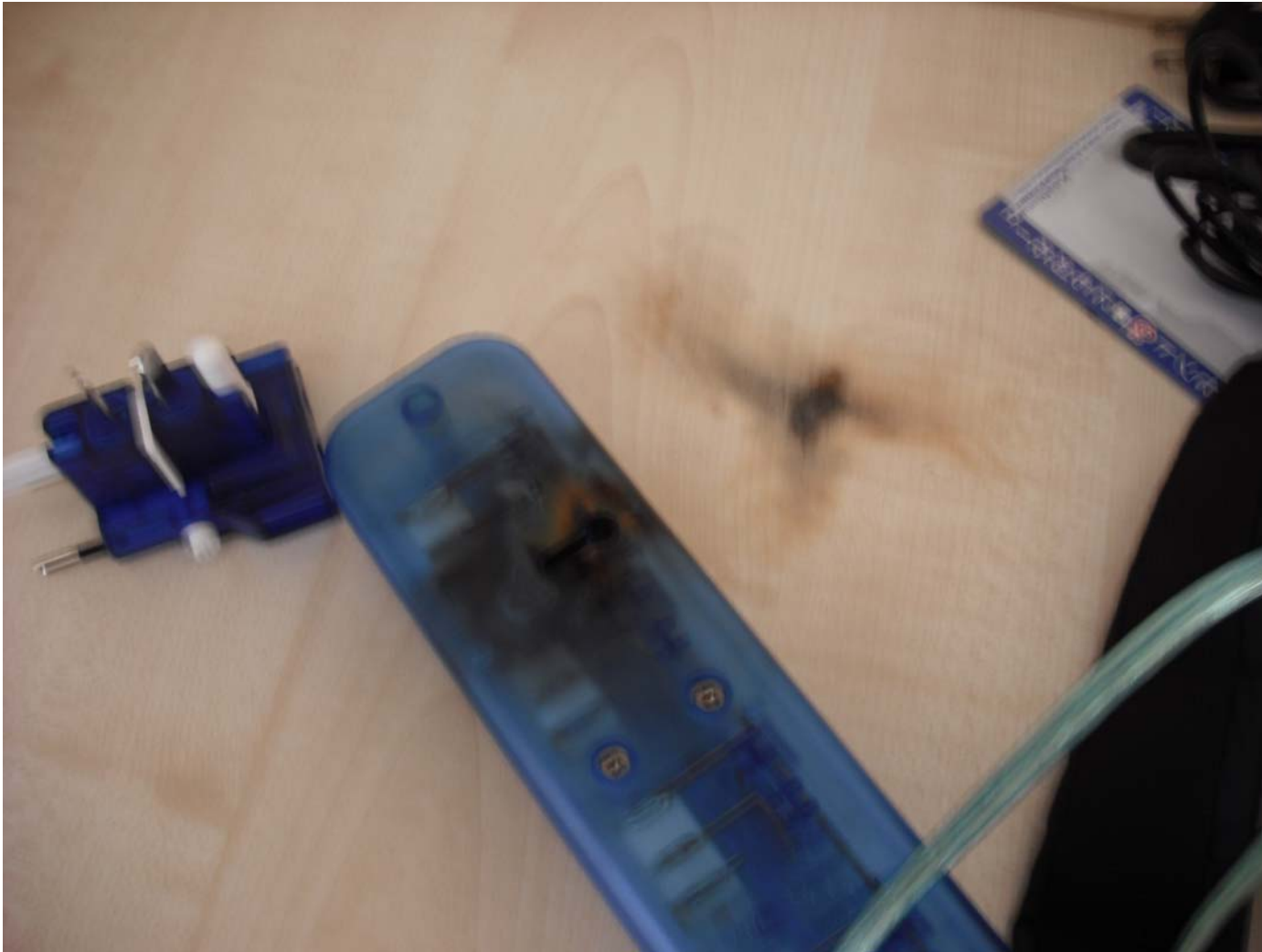
停電事件の原因となったマルチタップ
